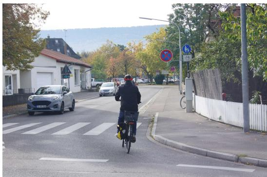
Die Einfahrt in den Radstreifen auf dem Gehweg ist zu schmal und birgt erhöhte Sturzgefahr durch die erhöhten Bordsteine.
